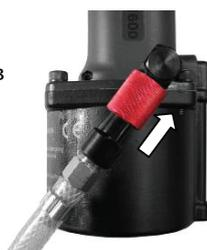
**Отключение подачи воздуха (OFF/ВЫКЛ):** передвиньте муфту в нижнее положение.
